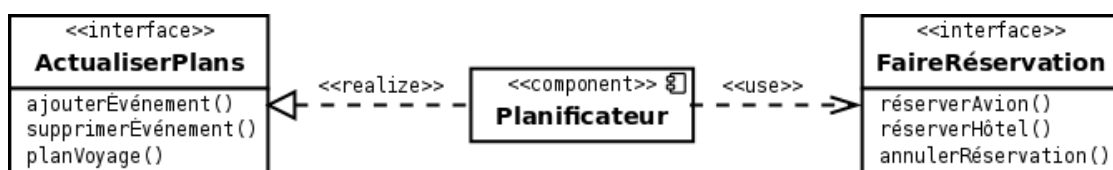
Figure 8.2 : Représentation d'un composant accompagnée de la représentation explicite de ses interfaces requise et offerte.
