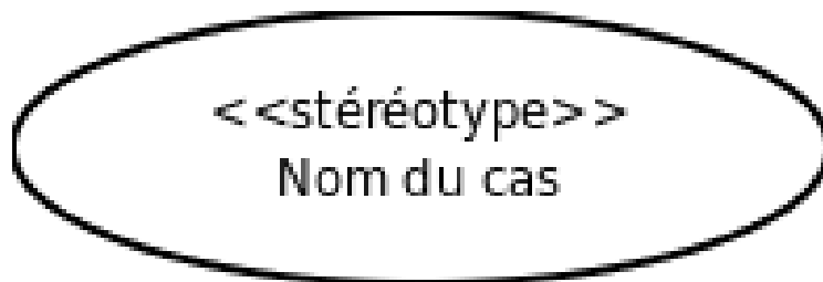
Figure 2.3 : Exemple de représentation d'un cas d'utilisation.
