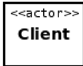
Figure 2.2 : Exemple de représentation d'un acteur sous la forme d'un classeur.
