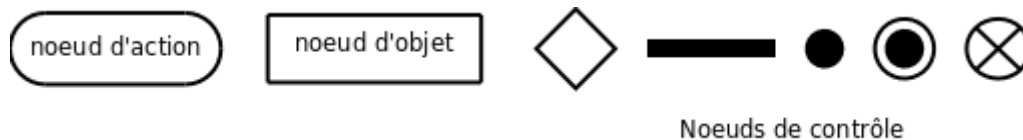
Figure 6.1 : Représentation graphique des nœuds d'activité. De la gauche vers la droite, on trouve : le nœud représentant une action, qui est une variété de nœud exécutable, un nœud objet, un nœud de décision ou de fusion, un nœud de bifurcation ou d'union, un nœud initial, un nœud final et un nœud final de flot.
